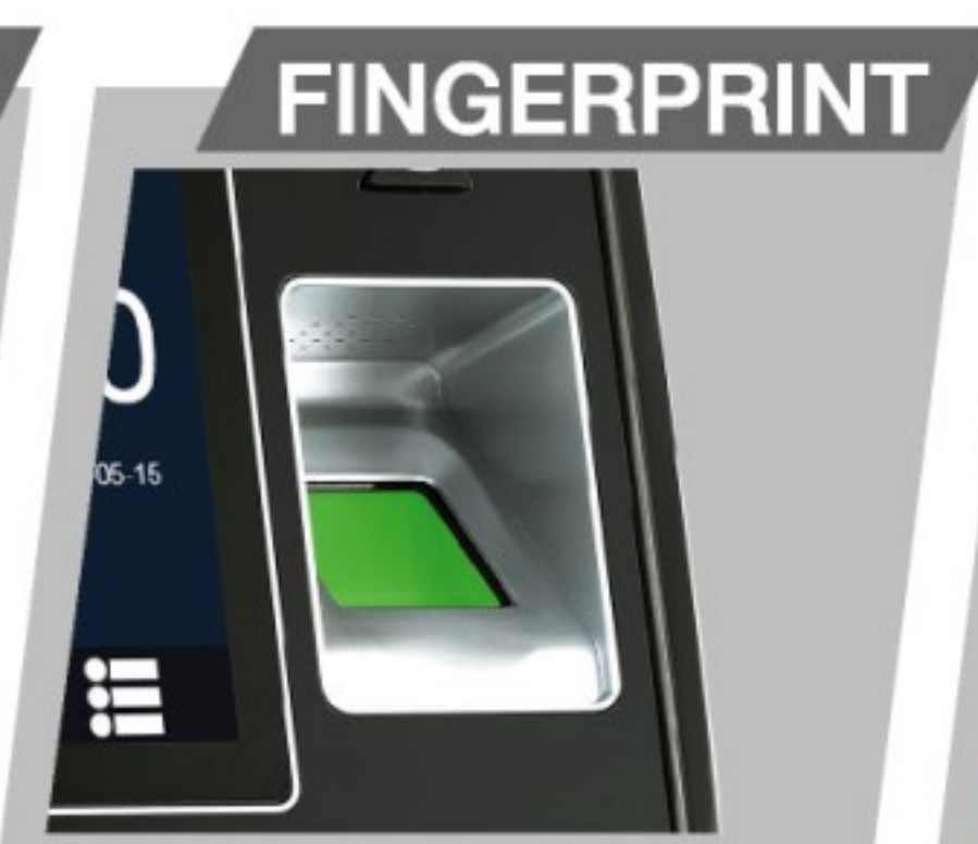
มาพร้อมกับระบบอ่านลายนิ้วมือ ที่ใช้หัวอ่าน Optical Fingerprint Sensor ที่ตอบสนองในมรทำงานที่รวดเร็วน้อยกว่า 1 วินาที
